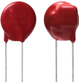
热保护型压敏电阻(Thermal Link & Varistors 简称 KOV@T)是合金型温度保险丝与压敏电阻通过内部有效热耦合结构实现即时取热的产品，具有过电压、浪涌和过温多重保护功能；本产品使用的压敏电阻具有高热容量和优良的过电压耐受能力，温度保险丝采用低阻抗的易熔合金，具有与压敏电阻相符的通流容量，且无接触电阻，在高浪涌电流冲击时不会发生永久性短路，在异常情况下确保压敏电阻失效后能迅速从电路中脱离，有效避免了火险隐患。
